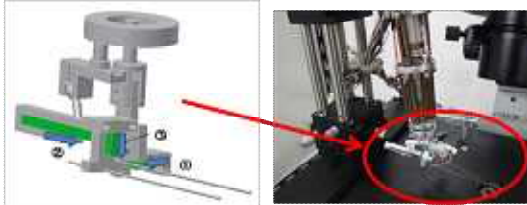
図5 指先位置合わせ用微調整機構
