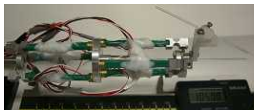
図1 パラレルメカニズムによる2本指マイクロハンド
