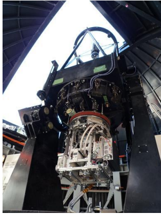
図2 MiniTAO 望遠鏡のとりつけられた近赤外線カメラ ANIR。
