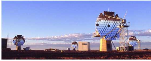
図1 南オーストラリア・ウーメラに設置された CANGAROO-III チェレンコフ望遠鏡アレイ
