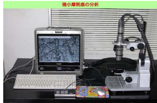
図1. デジタル顕微鏡による微小摩耗痕の分析
