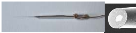
図1.単一胚の呼吸計測を可能とする超高感度ディスク型マイクロ電極。
