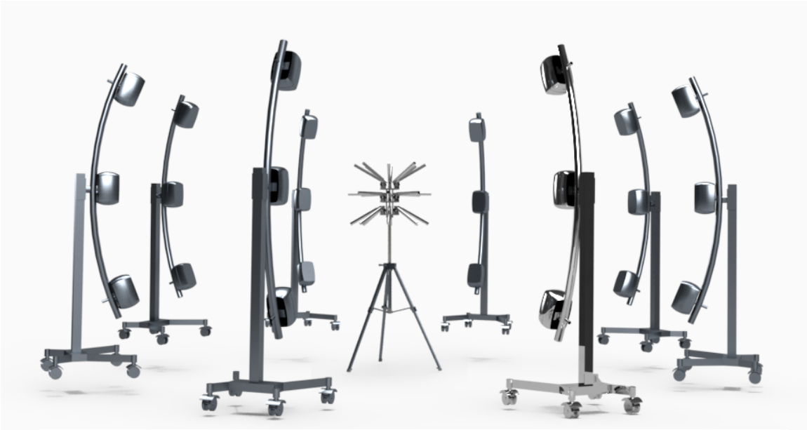
図1: 収録・再生のプラットフォーム (実際のシステム構築の際に用いた CAD の出力)
