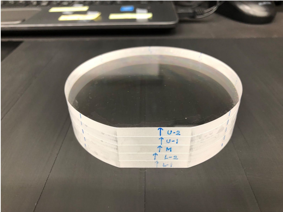
平坦に研磨された直径 100mm のサファイア半波長板を積層して接着した
