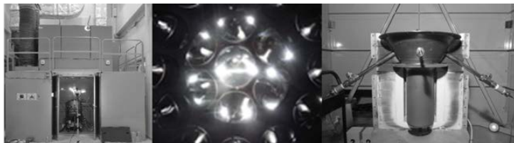
図3 新潟大 30kW th 太陽集光シミュレータ(左・中央)と30kW th 流動層式反応器(右)
