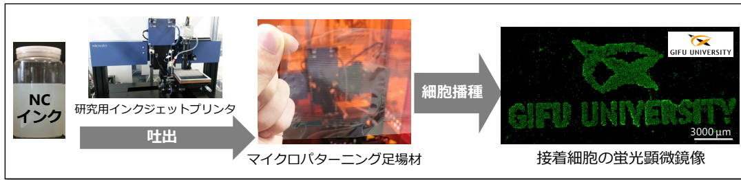
図1 NCインクのインクジェット印刷によるマイクロパターニング細胞培養足場材の調製スキーム
