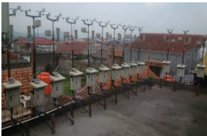
図1 バンドンの気象観測装置（遠隔操作のためのミニPCを付け足した後にテスト運転を一か所に集めて行った時の写真）
