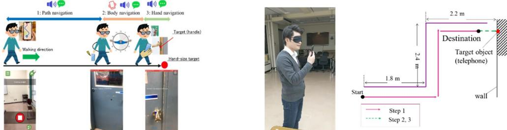
視覚障害者を利用者として想定して、手のひらサイズの目標物への3段階ナビゲーション法を提案した。提案手法の特徴は、カメラ付きウェアラブルデバイスを用いることで、視覚障害者が触るべき対象物まで円滑に到達できることである。本提案方式では、事前に映像の軌跡を設定するだけで、屋内のあらゆる状況に適用できる。ナビゲーションは、経路ナビゲーション、ボディナビゲーション、ハンドナビゲーションの3つのステージに分解される(左図)。経路ナビゲーションについては、先行研究の成果であるClewアプリを利用する。続く2つのステージではARアンカーを導入する。ARアンカーは、あらかじめ対象物に登録しておく。音によるガイダンスで手のひらサイズの分解能で目標物に到達できるよう、適切な音声ガイダンスを設計した。ステージの切り替えは振動で通知する。6.4メートル先の壁にあるインターフォンまでのナビゲーション実験を行った時の様子を右図に示す。
