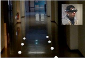
晴眼者向けの歩行ナビゲーション支援として、左図に示すようなARデバイスによる方向提示方法を提案した。歩行者の視覚による安全確認を妨げないように、進行方向を示すアクティブパターンは路面近くの左右に配置され、手前から奥に向かって流れているように提示される。左右に曲がる場合はアクティブパターンの流れが道なりに曲がっていく形で表示される。評価実験時に、ARデバイス内で注視点解析を行い、アクティブパターンを見ている度合いを調査した。
