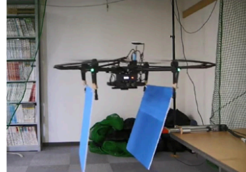
図 7 : 力覚センサを装着したリニアアクチュエータにより水平方向の提示力を計測する様子
