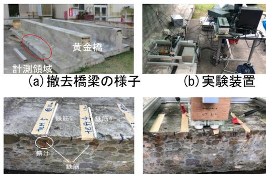
(c) 計測対象鉄筋 (d) 実験の様子
