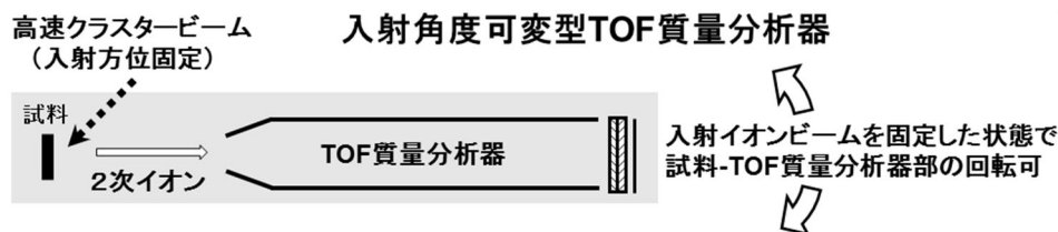
図 4 1 次イオン入射角度可変型 TOF 質量分析器
