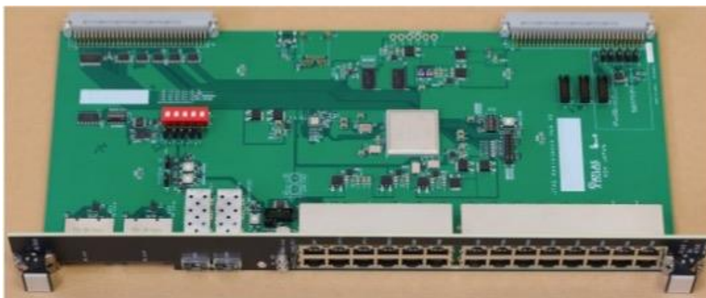
図 4: Thin Gap Chamber (TGC)の制御に用いられる予定である SoC デバイスを搭載した JATHub ボードプロトタイプ。本研究では SoC デバイスを用いた制御技術の高度化のアイデアを、JATHub ボード上に実装した。トリガー回路内の機能を標準的な計算機の一部のように扱う制御法や読み出し手法を確立した。
