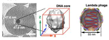
定するが,傾斜観察時の包埋材料の厚みが増加による試料コントラストの低下が問題となる. 今回 CFA を出発物質とした自己集合型フラーレン球状粒子を包埋材料として用いることで試料 コントラストを維持したまま高傾斜観察を実現し,たとえばバクテリオファージの DNA 構造を 捉えることに成功した.本手法は水中での中
