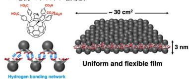
の強い凝集作用により真空下でも膜 形状を保つという知見に基づき,界面合成手法を用いて五重付加型フラーレンを二次元界面に押し込めることで「自立有機ナノシート」を作成することに成功し た.具体的には,5 つのカルボン酸部位をもつ円錐状フラーレン両親媒性分子(CFA)を気液界面にて集積化することで、数十 cm2 の面積にわたって柔軟かつ構造的 に均一な厚さ 3nmの逆二重膜へと自己組織化させ,フィルムとして単離することができた。理論的には、1g の両親媒性物質で 300m² もの広さを 3nm の膜で覆うことが できる。この逆二重膜構造の特徴として、単純に CFA の濃度を上げるだけで容易に多層膜を形成することも明らかとなった.これらのフィルムは、逆二重膜構造を 維持したまま、さまざまな平面または穴の開いた基板に転写することができ,例えば,金の櫛形電極に転写したフィルムは、1.4 x 10-4 S cm² までのプロトン伝 導性を示した。このフィルムはアモルファスで柔軟性があり,電子線を照射すると巻き上がるという,屈曲電気特性を示す。
