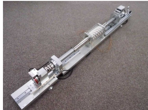
図1 クロスカップル形円筒 二自由度表面磁石モータ
