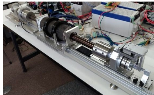
図3 ハルパツ八磁石配列を適用した二自由度表面磁石モータの試作機
