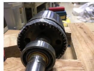
図 2: ビスマス系高温超伝導かご形回転子の外観写真
