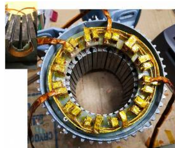
図 1: 希土類系高温超伝導固定子の外観写真(挿入図: 固定子スロットに希土類系巻線を施工した様子)
