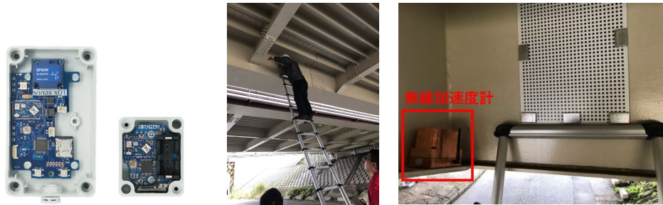
図 3 無線加速度計による橋梁応答計測
