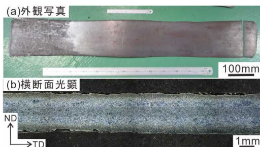
図6 低炭素鋼(JIS-SS400)と高炭素鋼(JIS-SK5)の大型積層材の外観写真(a)と横断面光学顕微鏡組織(b)。表層部に厚さ200μm程度の低炭素鋼層が存在する。
