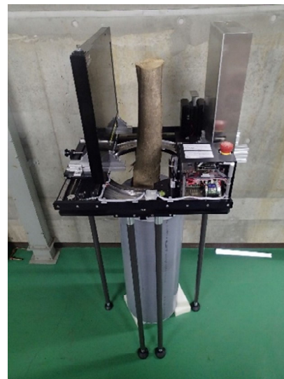
写真1 試作した立木用X線検査装置
