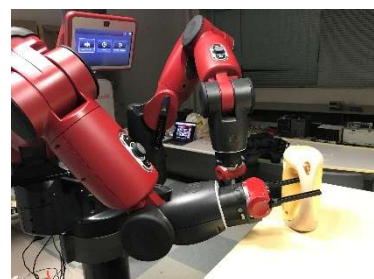
図 6：計画されたロボットの挿入動作
