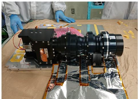
図6：紫外線望遠鏡フライトモデル
