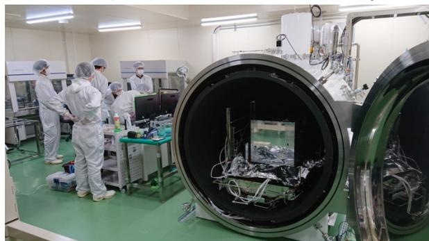
図7：紫外線望遠鏡の熱環境試験
