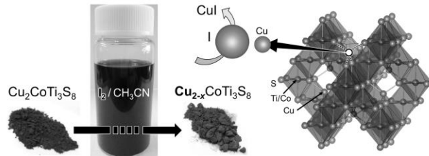
図 2 ヨウ素アセトニトリル溶液を用いた \text{Cu}_2\text{CoTi}_3\text{S}_8 からの Cu の酸化抽出。
