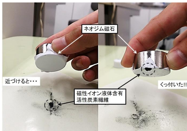
図1 合成した磁性イオン液体-活性炭複合材料
