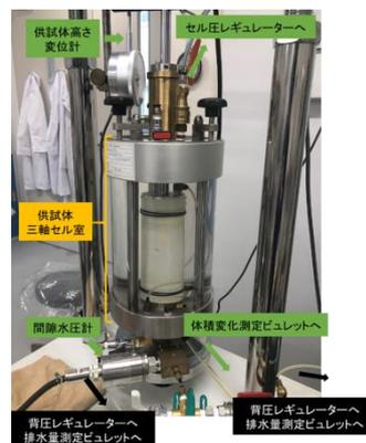
図2 三軸試験装置
