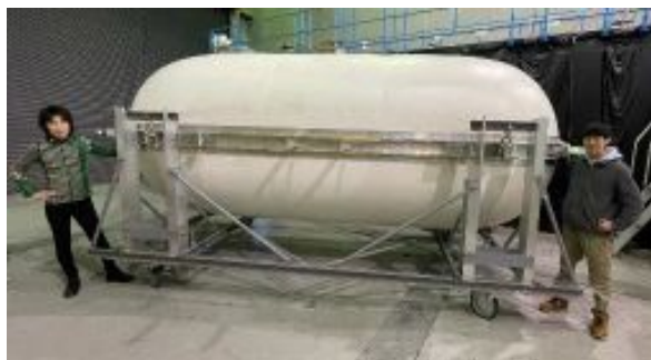
図10：樹脂膜製長繭型風船式与圧容器ゴンドラ
