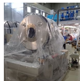
図 2 滑らかな磁場接続のための BS 磁石
