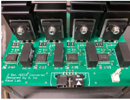
図 5 SiC HE ECS インバータの写真
