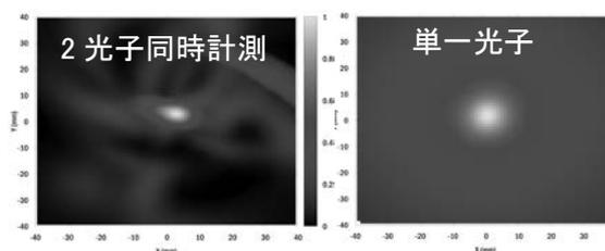
図2: 4mm径のマイクロチューブに保持した2光子放出核種<sup>43</sup>Kの放射能分布の2光子同時計測画像と単一光子画像
