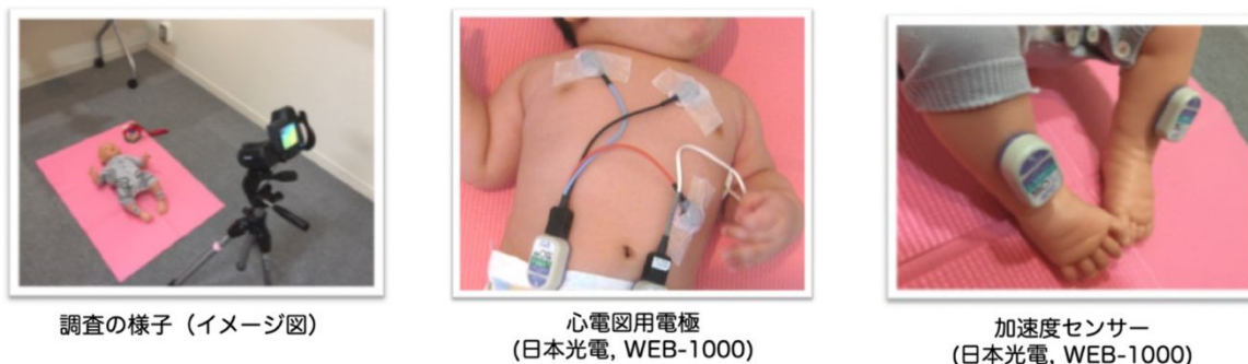
図1. 調査の様子および計測機器の装着図
