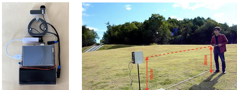
(a) 受信機 (b) 屋外実験. スピーカから合成音を放射. 図 9 制作した受信機と屋外実験の様子
