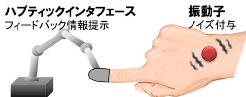
図1. 触感覚向上機能を有する、手指を用いた運動学習。「ノイズ付与による指先知覚の向上」と「ハプティックインタフェースによる、指先への訓練支援用力情報提示」から構成される。
