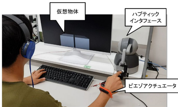
図 2. 指先触感覚向上機能を有する VR 訓練システム
