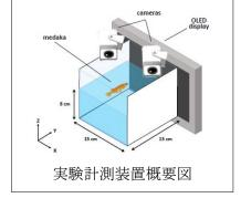
実験装置全体では、以下のプロセスを経て、人工 物とメダカ間の相互作用の循環構造を形成してい る (双方向相互作用システム図). (1)2 台のカメラ で取得したメダカの画像からステレオマッチング によって, 水槽内のメダカの3次元位置をリアルタ イムに推定する. (2)メダカの行動系列を入力とし て、メダカへの視覚刺激の動きを計算する. (3)計 算結果をディスプレイ上に表示し, メダカへの応答 とする.
