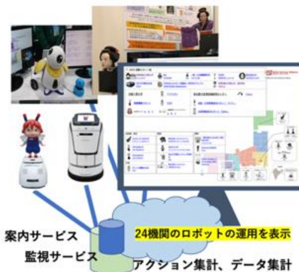
図 2 異機種のロボットの連携運用のシステム
