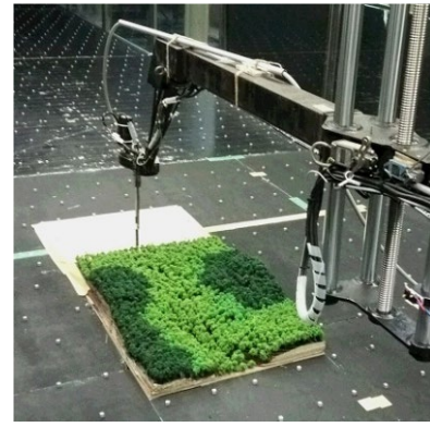
図 1 風洞実験状況と森の模型
