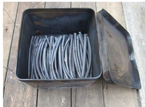
図2 伊那式炭化法で焼いた竹炭
