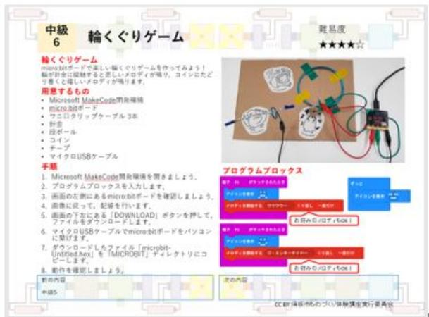
図2 micro:bit 実験用教材の一例
