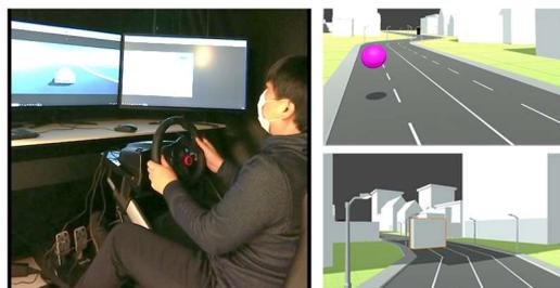
図1 ドライブシミュレータによる自動運転(左)及び走行画面(右：障害物)の例。
