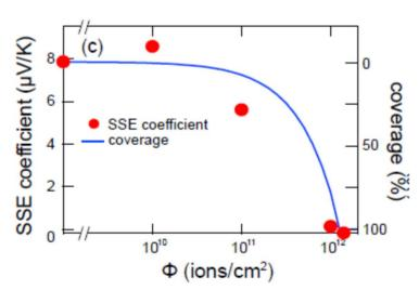
鉄ガーネット(YIG)にはイオンの通過した部分に直径が 20nm のアモルファス領域(円柱状欠陥)が形成されることが知られている。図の右軸は照射量によって試料表面をアモルファス領域が覆う被覆率を示したものである。アモルファス領域は磁化を失っているので照射量が増えるとYIGの磁化が減り、それによって金属層であるプラチナ層へのスピン流注入が減少すると考えられる。実際の使用済み燃料キャスクでは表面の核分裂片による高エネルギー重イオン密度は~4x10<sup>8</sup> ions/cm²/年 程度であるので、スピンゼーベック効果素子の寿命は数百年に渡って保持されることがわかった。この結果については現在論文投稿中である。
