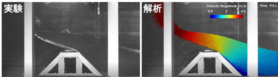
図3 Case1 の盛土模型付近の波形(非碎波)の比較(粒子の色は流速)
