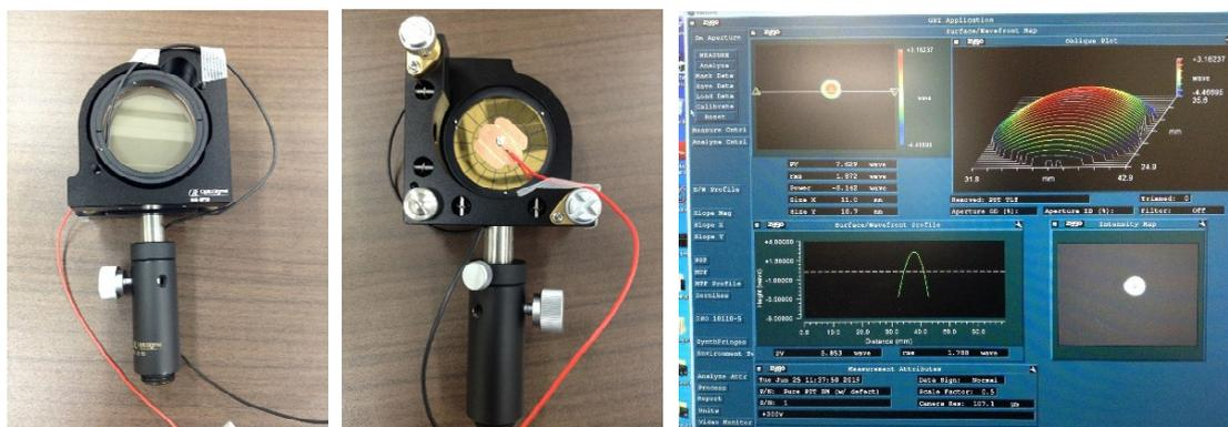
図 7: 実験用に配線を施しホルダーに固定された純圧電材可変形鏡。左は表面、中央は裏面、右は干渉計による変形量測定。
