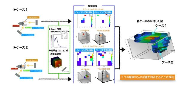
事象のバーテクス3次元再構成は、最尤法の考え方で行なった。すなわち、ある点でシンチレ ータが発光したと仮定して、2つのカメラと5 inch PMT への期待されるシグナルの確率密度を 計算し、実際に観測されたシグナルに対するそれらの関数の積(ライクリーフッド積)が最大となるような発光点を求めた。図中一番右側のプロットが、そのようにして求まった、再構成された発光点の3次元的な分布である。線源を置いた位置に対応する場所に発光点の分布が現れており、液体シンチレータ撮像によって、バーテックスが検出されたことを示している。
