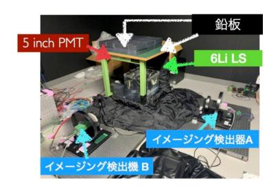
(6) 下図は、今回の測定の流れを示している。線源をシンチレータボックスの上面、側面に置 いた2つのケース(図中、「ケース1」「ケース2」)について測定を行い、2つのカメラと、5 inch PMT からのシグナルを統合して、事象を再構成した。
