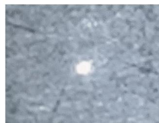
図 2 空間捕捉された In 微粒子の光学顕微鏡像
