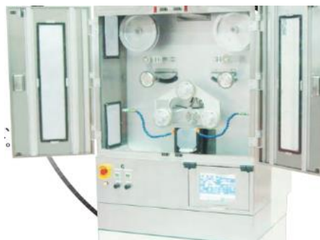
図 8 電界スライシング技術実証実験用試作装置
