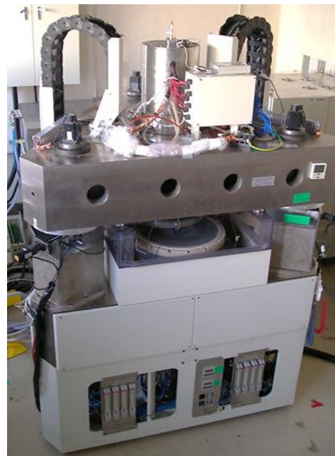
図1 開発した 450mm ウエハ用ロータリ研削盤
