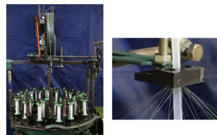
図 2 製紐機による人工筋の製作
