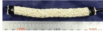
図7 SMP 繊維搭載型人工筋
