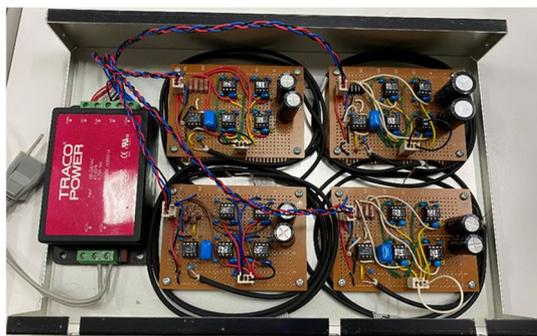
図2 4アンプ並列増幅式のアンプ4回路
