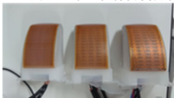
図 2 分布方式及び CoP 方式の触覚センサシートを備えたロボット指
