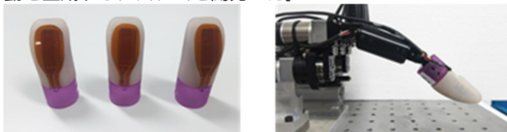
図 1 2 層型荷重分布重心位置検出センサのロボット指への実装
