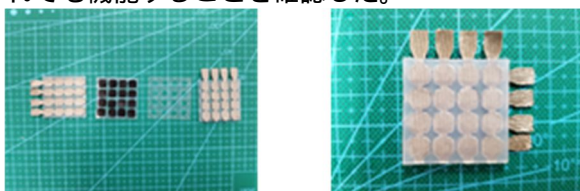
図 3 導電性繊維を用いた伸縮可能な触覚センサ構成の例
