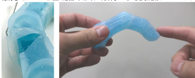
図 4 シリコンゴムの硬化阻害を利用したロボット指
