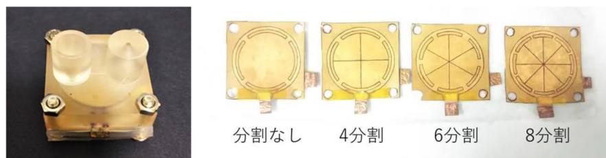
図 3 ポンプ駆動用ダイアフラム型素子(左:ポンプ、右:パターニングした IPMC)
